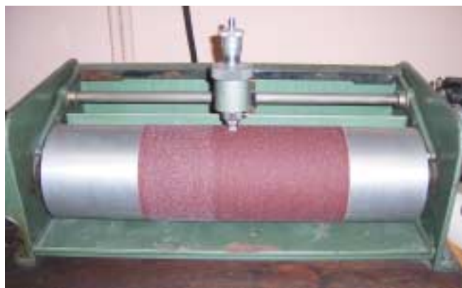
Рис. 1. Машина для испытаний на абразивный износ
